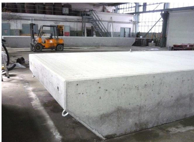
Im Vordergrund das eine Teilstück, im Hintergrund das zweite. Die soliden eingegossenen Augen dienen zur Verbindung mit der bestehenden Anlage mittels kräftiger Ketten.
