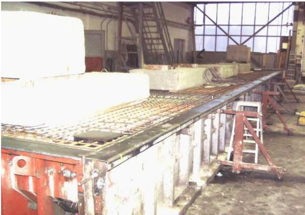
hier ist die Form vorbereitet zum Betonieren
