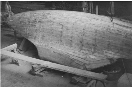
knackte und krachte. Spanten brachen. Das Schiff wurde um 20 cm breiter. Danach wurden Rundeisen diagonal durch das Schiff geschoben, um es zu fixieren.
