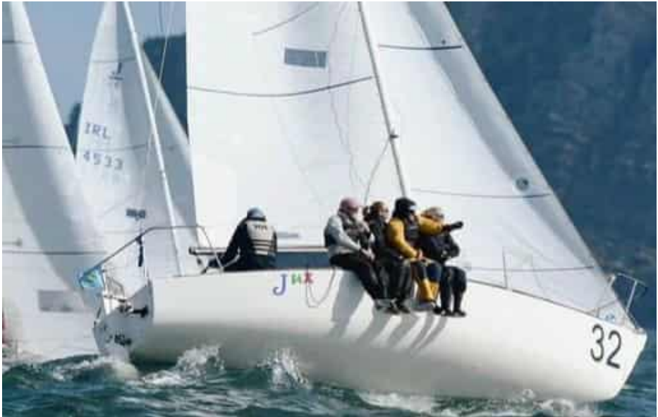
J 24, eine Erfolgskonstruktion, kann aber kentern und auf Grund sinken, wenn die Backskisten nicht dicht sind
