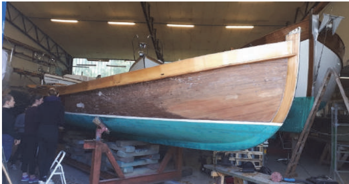
....hier ist der erste Lack bereits abgezogen
