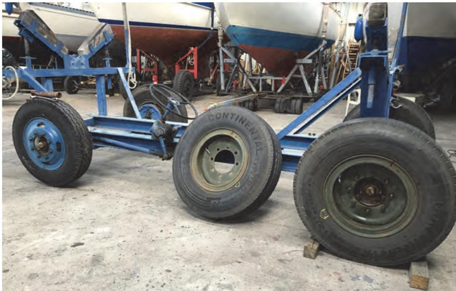
Endlich wurde ich fündig bei einem bayerischen Händler, der Räder aus Bundeswehrbeständen, nur wenige Jahre alt und in gutem Zustand und ohne Risse anbot, in der Größe 10 R 20. Für die Laien unter uns: die 10 bedeutet grob die Reifenbreite- und Höhe, die 20 steht für den Felgendurchmesser. Also, jetzt musste es nur noch eine 8-Lochfelge mit dem richtigen Lochkreisdurchmesser
