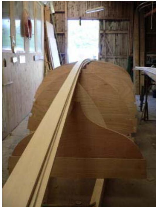
Für den formverleimten Rumpf, der kopfüber gebaut wird, müssen zunächst die Mallen aufgestellt werden, über die dann nach Einbau von Kiel, Balkweger und Spiegel der Rumpf verleimt wird.
