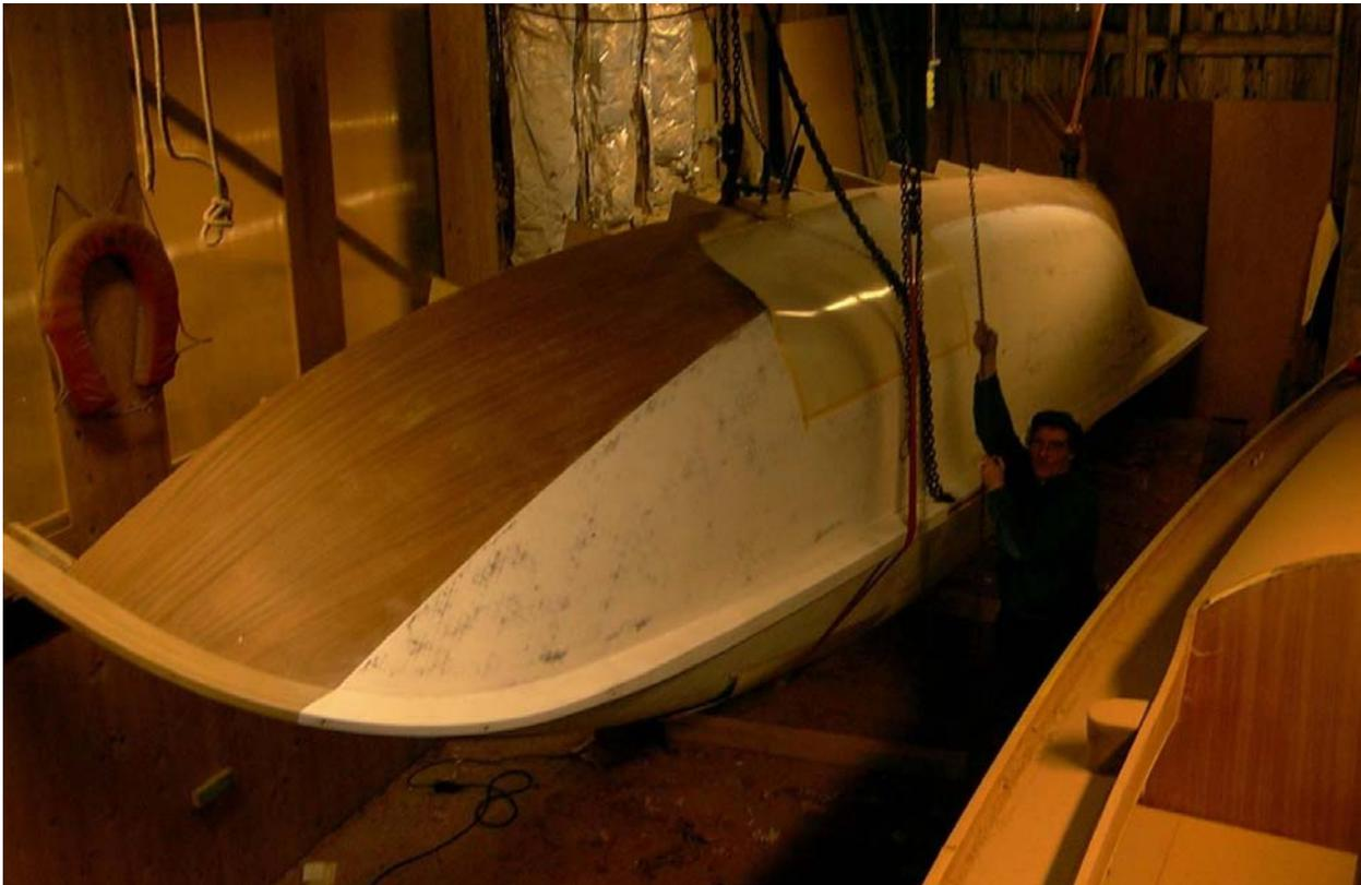
Das Umdrehen erfolgte mit Hilfe eines Kettenzuges.
